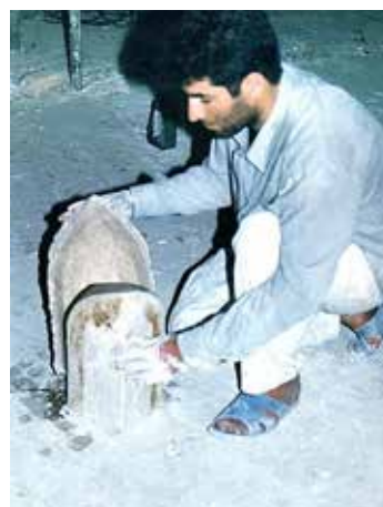
تصویر شماره ۴۴: نمود جداسازی قالب مادگی از قالب نری؛ مأخذ: نگارنده
