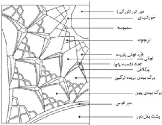
تصویر شماره ۲۱: یک دوم تصویر شماتیک یزدی بندی شمشه‌دار از شکل ۲۲، کاروانسرای وکیل کرمان (دوره قاجاریه)؛ ترسیم: علی صادقی دانشجوی دکتری معماری؛ کنترل: نگارنده
